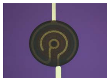
Electrodes de supercondensateur Le charbon actif est déposé par jet d'encre sur des électrodes métalliques
