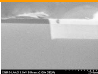
Gravure profonde de la silice fondue pour application microfluidique
