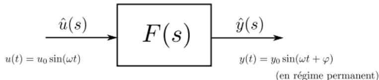
**Définition** : la réponse fréquentielle d'un système LTI est définie comme l'ensemble des réponses du système en régime permanent à des entrées sinusoïdales en fonction de la pulsation
