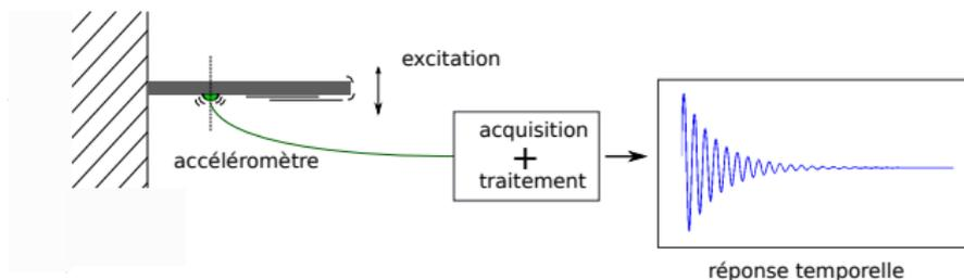
$\Rightarrow$  Objectif : estimer les fréquences de résonance d'une structure mécanique.
