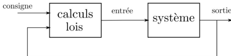
⇒ schéma de commande en boucle fermée<sup>2</sup>
