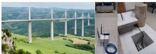
Viaduc de Millau : l'un des ouvrages d'art les plus instrumentés de France ; et la configuration expérimentale employée au laboratoire pour tester un réseau de capteurs sans fil, sans batterie, téléalimentés et enfouis dans une poutre de béton armé afin de suivre son bon vieillissement.
