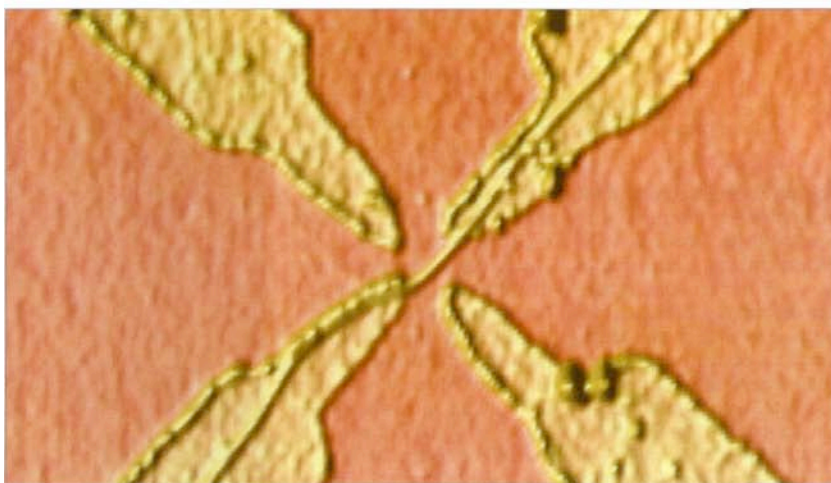
Nanotube de carbone (en jaune) reliant les électrodes d'un prototype de transistor.
