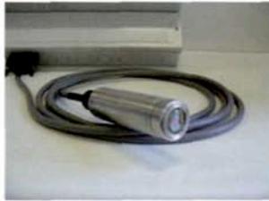
Figure 3 : Zoom sur la sonde de mesure du Biosys™-TK (gauche) et le capteur (droite) réalisé en technologies microsystèmes (microélectrodes), pour la mesure qualitative et semi-quantitative d'encrassements épais.
