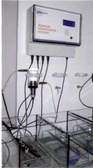
Figure 1: Système de mesure Biomosys™-TN en fonctionnement avec 4 sondes en parallèle pour la détection précoce d'un biofilm en eaux potables. Les sondes sont immergées ou utilisées, de manière classique, en chambre de circulation.
