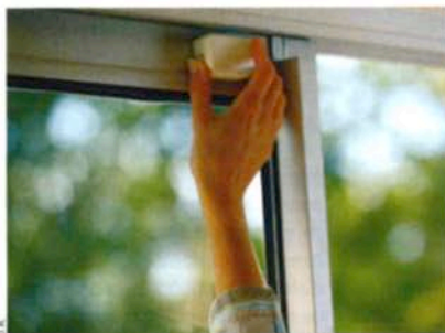
Chaque capteur, mis en place par l'utilisateur, peut, via une centrale, envoyer des messages SMS.
