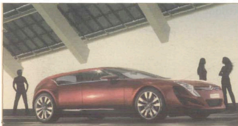
C-Métisse, le concept-car de Citroën, possède 3 moteurs et une nouvelle ergonomie du poste de conduite, tout à fait originale. Les 2 moteurs additionnels se situent au niveau des roues arrière et développent une puissance de 20 cv chacun.
