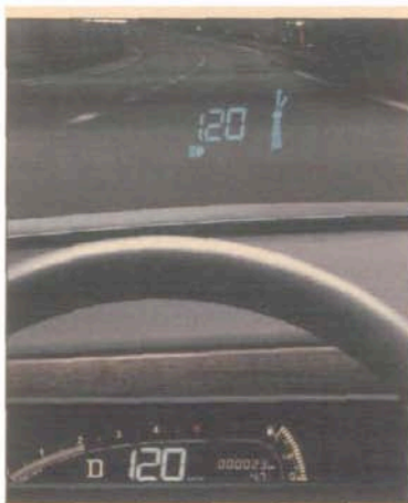
Affichage tête haute. Cette technologie existe déjà de série dans certains véhicules.
