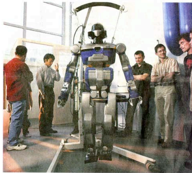
Arrivé en mai à Toulouse, le robot japonais HRP-2, même s'il se déplace bien, reste relié par les épaules à une potence de sécurité. PATRICK AVENTURIER/CNRS/GAMMA
