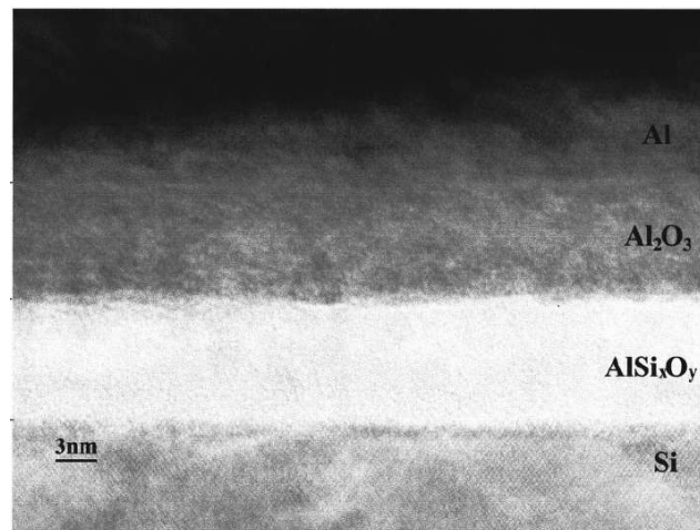
Figure 18: Image MET prouvant la formation d'une silicate à base d'aluminium pendant le dépôt CVD à 400 °C d'alumine sur silicium [Klein].
