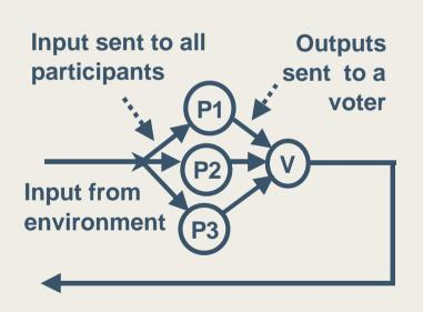
**Triple-Modular Redundancy (TMR)**
