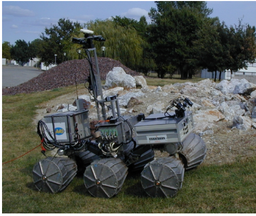
FIG. 4 – Le robot Lama. La caméra panoramique n’est pas visible sur cette photographie - elle était montée en haut du mat central, près de l’antenne GPS blanche.
